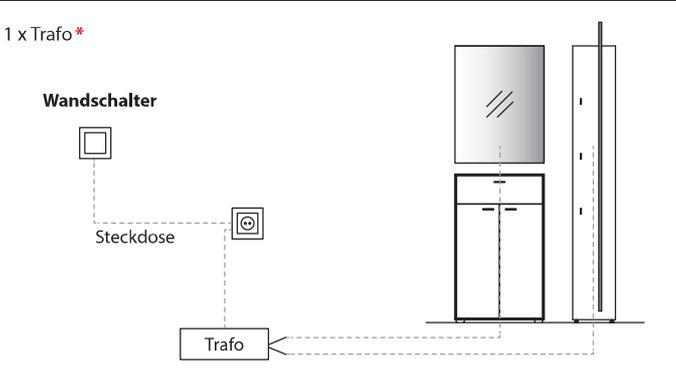
Die Beleuchtung wird mit einer ausreichenden Anzahl an Trafos, inklusive einem Schalter, geliefert. Optional kann der Schalter durch einen Funkdimmer ersetzt werden, sodass Sie die Beleuchtung per Fernbedienung bequem vom Sofa aus steuern können. Diesbezüglich sollte dem Auftrag unbedingt eine Planungsskizze hinzugefügt werden.
