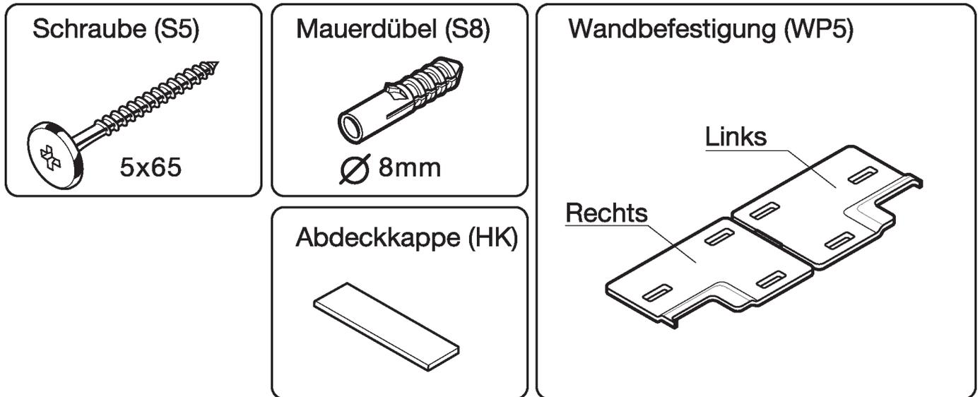
Das beiliegende Montagematerial (Schrauben und Wanddübel) ist nur für Massivwände geeignet. Informieren Sie sich vor der Wandmontage über das geeignete Montagematerial für Ihre Wand.
