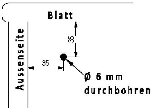
Bitte befestigen Sie die Möbel mit beiliegenden Schrauben (5x90) am Mauerwerk (**Kippsicherung**). Hierfür ist in der oberen linken und rechten Ecke eine Verstärkung hinter der Rückwand angebracht.
