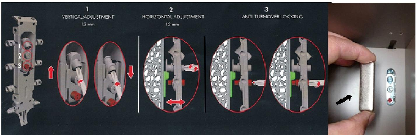
**Wichtiger Hinweis:** Sicherungsschraube 3 sollte beim einhängen ganz rausgedreht und Schraube 2 ganz reingedreht sein. Nach kompl. Ausrichtung die Sicherungsschraube 3 wieder ganz reindreihen. Alle Einstellungen mit einem Schraubenzieher bedienen nicht mit einem Akkuschauber. Abdeckkappe aufsetzen, fertig.
