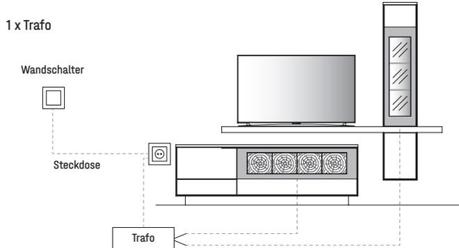
Bitte am Ende Ihrer Planung die Gesamtwattzahl ermitteln und den/die entsprechende(n) LED-Trafo(s) sowie die gewünschte Schaltervariante(n) definieren. Optional kann der Schalter durch einen Funkdimmer ersetzt werden, sodass Sie die Beleuchtung per Fernbedienung bequem vom Sofa aus steuern können. Diesbezüglich sollte dem Auftrag unbedingt eine Planungsskizze hinzugefügt werden.
