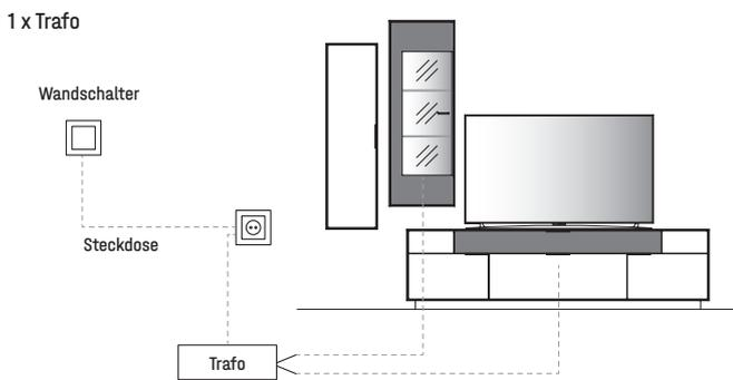
Bitte am Ende Ihrer Planung die Gesamtwattzahl ermitteln und den/die entsprechende(n) LED-Trafo(s) sowie die gewünschte Schaltervariante(n) definieren. Optional kann der Schalter durch einen Funkdimmer ersetzt werden, sodass Sie die Beleuchtung per Fernbedienung bequem vom Sofa aus steuern können. Diesbezüglich sollte dem Auftrag unbedingt eine Planungsskizze hinzugefügt werden.
